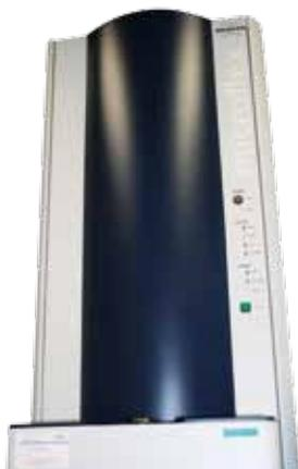
Le «MALDI-TOF» est un spectromètre de masse (MALDI, Matrix-Assisted Laser Desorption/Ionisation - TOF, time-of-flight mass spectrometry)
